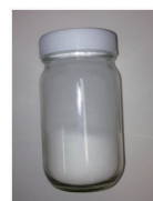
溶融/ドライプロセスで 得られたPLA粉末
