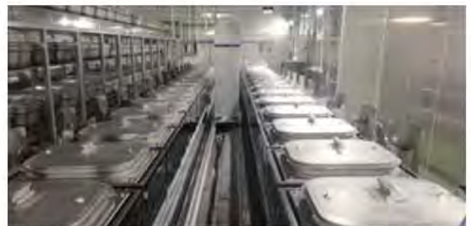
「単釜式自動炊飯システム」の単釜式炊飯器。中央のレール上を動く釜搬送口ポットが、出来上がった釜を次工程に搬送する。
