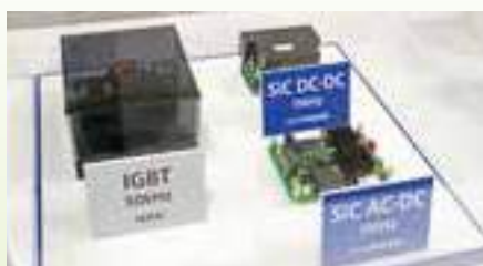
ニチコン（株）が開発した、SiCを用いたDC-DC電源、およびAC-DC電源
