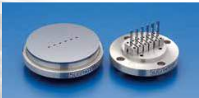
独自の金型位置決め機構を採用した粉末成形金型
