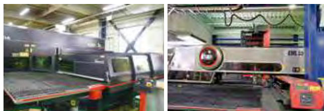
異種金属にも対応できる最新鋭のファ イバーレーザーパンチの複合機 成型・異形状の複合同時加工を実現する レーザーパンチ複合機
