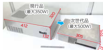
X線発生装置用電源 1Wあたりの容積として従来の約5分の1に小型化
