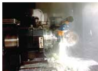
NC工具研削盤による鏡面研削加工の様子
