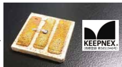
※SiCチップの実装については舟木研究室のご協力のもと行いました。 低熱膨張インパーめっき技術(KEEPNEX®)を 応用したセラミックス基板
