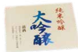
フィルム交換によって、光沢加工だけでなく 色を替えての箔加工もできる
