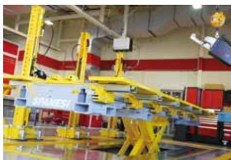
ミリ単位の正確さ・スピードで修復できるイタリア・スパネージ社の治具式フレーム修正機
