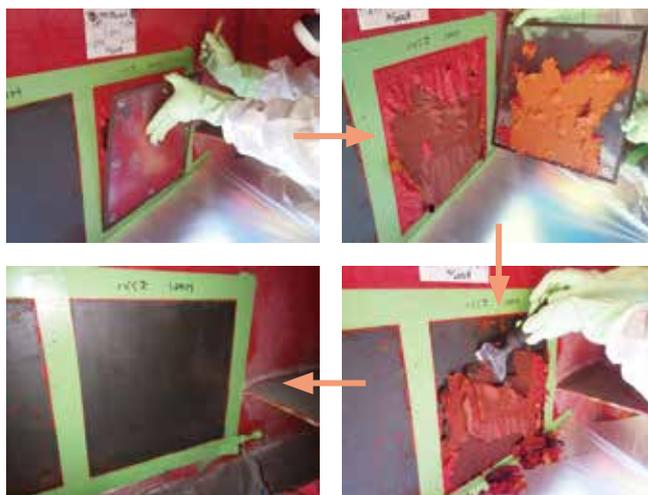
滋賀県・新石田川橋の耐震補強補修工事における、「MAGバック」を用いた剥離試験の様子
