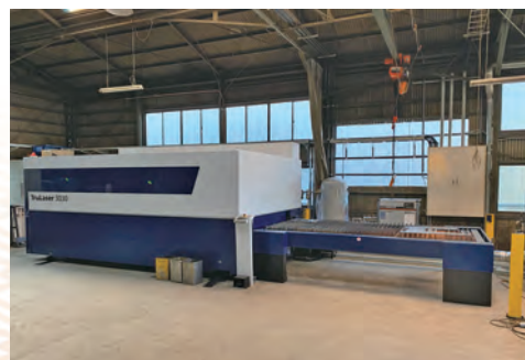
ブランク工程を強化するためファイバー式ディスクレーザー加工機を導入
