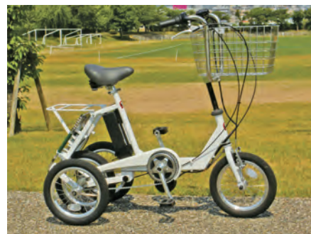
シンクロシステムを搭載した超小型電動アシスト自転車(初号試作車)
