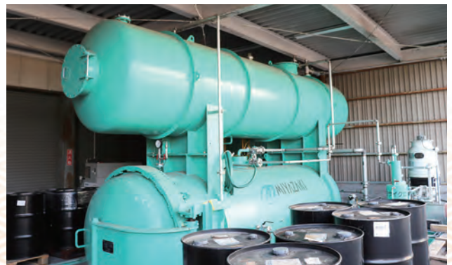
木材の不燃化に注力すべく、最新の真空含浸装置を導入
