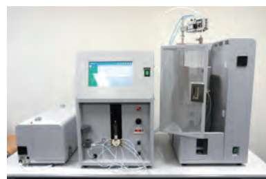
新システムを搭載した燃焼式のラボ用TOC自動計測装置（画面から様々な設定を行い検査を行うことができるテスト用の試験機）
