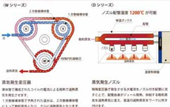
トクデンが生み出した画期的な過熱蒸気発生装置。変圧器方式で最高温度700℃を達成
