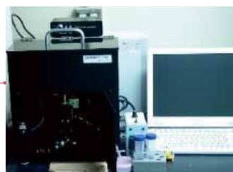
SPR蛍光センシングデバイス(株UBM) 肝臓マーカーをはじめとする各種腫瘍マーカーを光学的に検出
