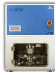
iPSアカデミアジャパン(株) 簡易型iPS細胞自動培養装置 細胞を育成する培地等を自動で 交換する装置
