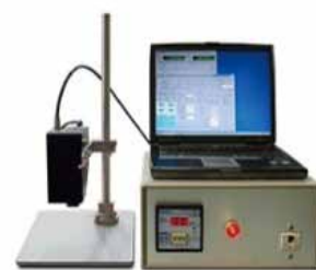
(株)井元製作所 非接触硬度計 圧縮した空気では生体材料を 破壊せず硬度を計測
