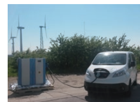
I_DENCON10kVAを利用し、電力をEVへ充電
