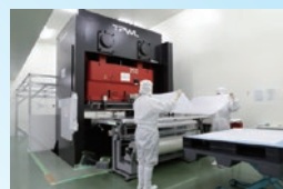
超大型加工 ワークサイズ2,000mm×1,200mm
