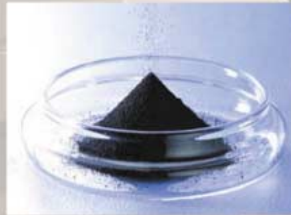
京都市クリーンセンターのゴミ焼却炉で使用されているダイオキシン吸着剤「複合炭素系ダイオキシン吸着剤 Hi-Mox(ハイモックス)」。 【(株)カーボテック(平成11年～15年VIL入居)開発】
