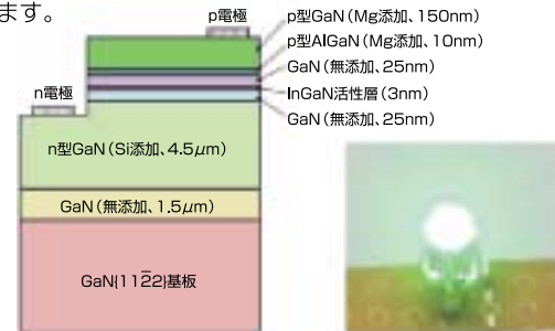
図：LEDの構造と写真
