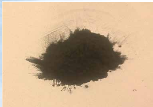
ハイパー電池実現の要となる高容量負極材SCC シリコンと炭素の複合活性物質であり、 従来材料の4倍程度、1,200mAh/gという大きな容量を有する。
