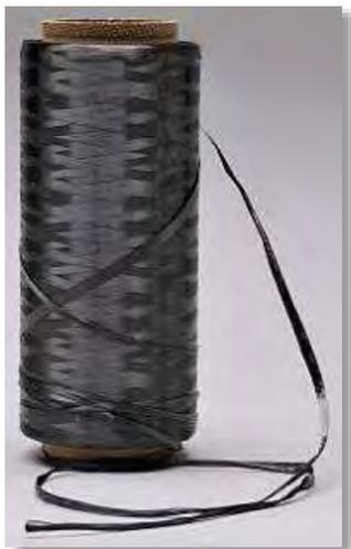
ポリアクリルニトル樹脂や石油、石炭からとれる樹脂状の物質(ピッチ)等を繊維化して、その後、特殊な熱処理工程を経て作られる「微細なグラファイト結晶構造をもつ繊維状の炭素物質」です。また、炭素繊維は、軽くて、優れた機械的な性質（高比強度、高比弾性率等）と炭素質からくる優れた特性（導電性、耐熱性、低熱膨張率、化学安定性、自己潤滑性、高熱伝導性、生体親和性等）を併せもつため、工業用途では、航空機・クルーザー・車両・住宅等のインテリア・エクステリア製品、商業用途では、アパレル製品・スポーツ用品・カバンなど、色々な用途に幅広く使われています。
